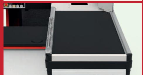
**Módulo delantero** con cinta con doble tela negra de PVC antistático y poliéster. Motor con potencia de arrastre alta, enfriamiento con aceite, arranque gradual opcional. Fotocélula con sensor doble para una mayor seguridad.
