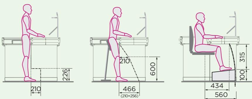
Section du compartiment des jambes pour la position debout avec et sans support et la position assise.
