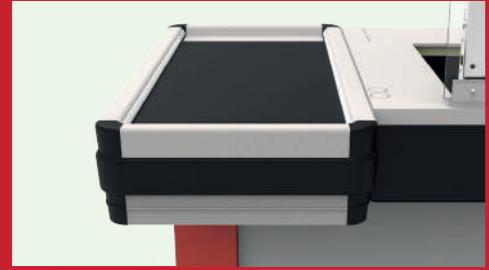
**Módulo delantero** con cinta con doble tela negra de PVC antistático y poliéster. Motor con potencia de arrastre alta, enfriamiento con aceite, arranque gradual opcional. Fotocélula con sensor doble para una mayor seguridad.
